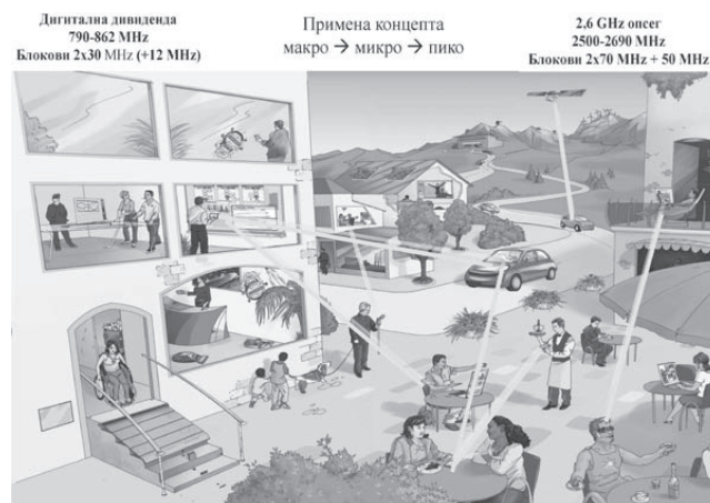
Слика 5.2. На квалитет сервиса/задовољство корисника утичу покривање и капацитет линка
